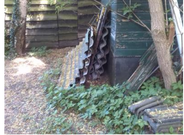
Figuur 7: Opslag asbestgolfplaten
