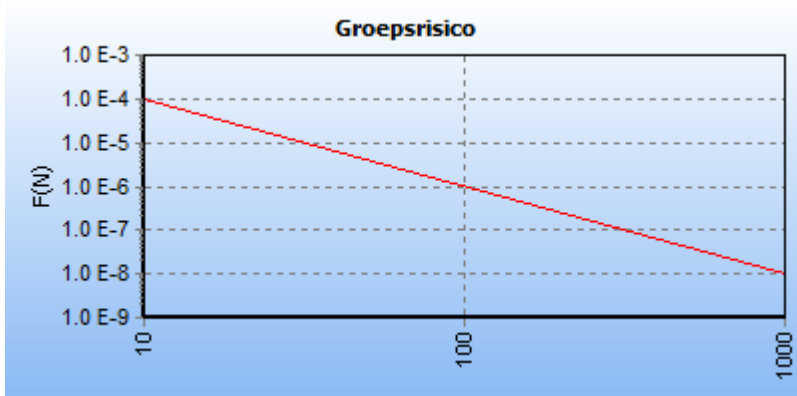
5.4 Figuur 5.4 FN curve voor 2166_leiding-N-528-70-deel-1 van N.V. Nederlandse Gasunie voor de kilometer tussen stationing 0.00 en stationing 0.00
