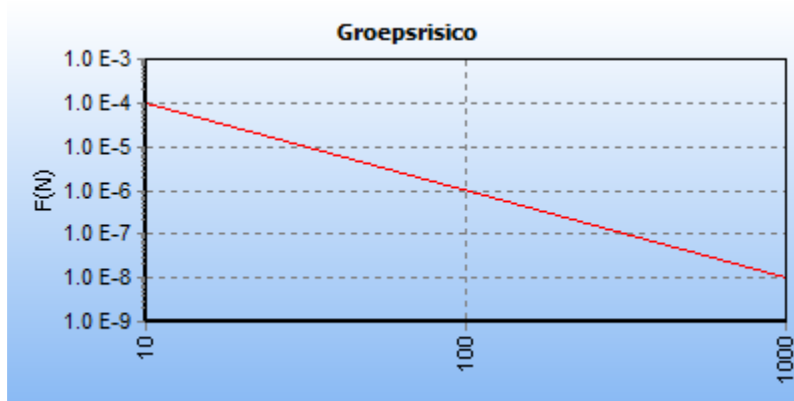
Figuur 3.8: fN-curve buisleiding 2166-leiding-A-670-deel-1 ná planrealisatie
