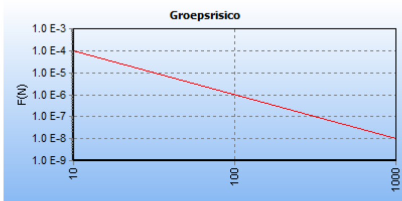
5.6 Figuur 5.6 FN curve voor 2167_leiding-N-528-70-deel-2 incl.verl van N.V. Nederlandse Gasunie voor de kilometer tussen stationing 1360.00 en stationing 2360.00
