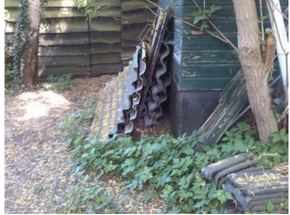
Figuur 7: Opslag asbestgolfplaten
