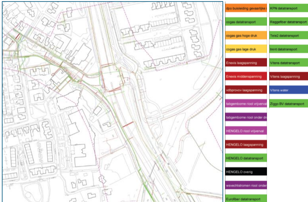
Figuur 12: belangrijkste kabels en leidingen kruispunt N743 / Grotestraat.
