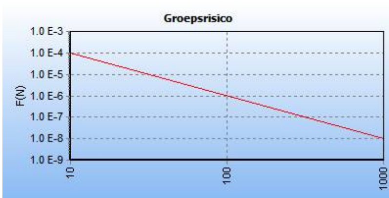
5.2 Figuur 5.4 FN curve voor 5434_leiding-A-670-deel-1 van N.V. Nederlandse Gasunie voor de kilometer tussen stationing 810.00 en stationing 1810.00
