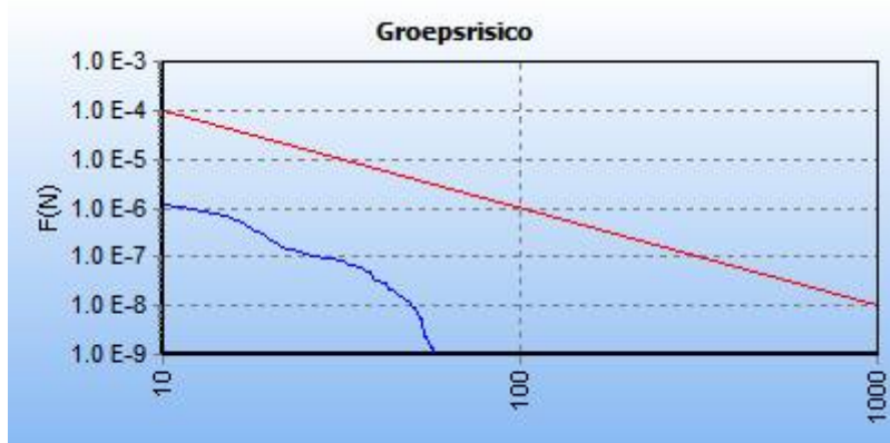
5.3 Figuur 5.6 FN curve voor 5434_leiding-N-528-70-deel-1 van N.V. Nederlandse Gasunie voor de kilometer tussen stationing 5580.00 en stationing 6580.00
