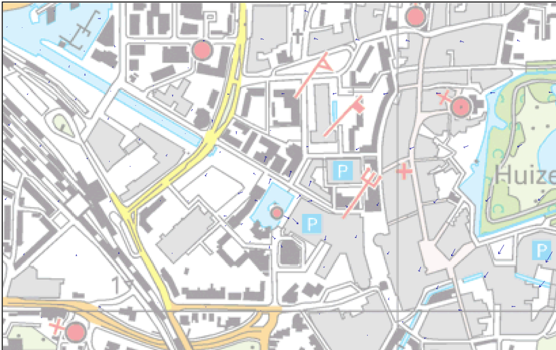
Figuur 4.2: Stromingsrichting grondwater freatisch pakket (De lengte van de pijljes geven de stromingssnelheid aan)
