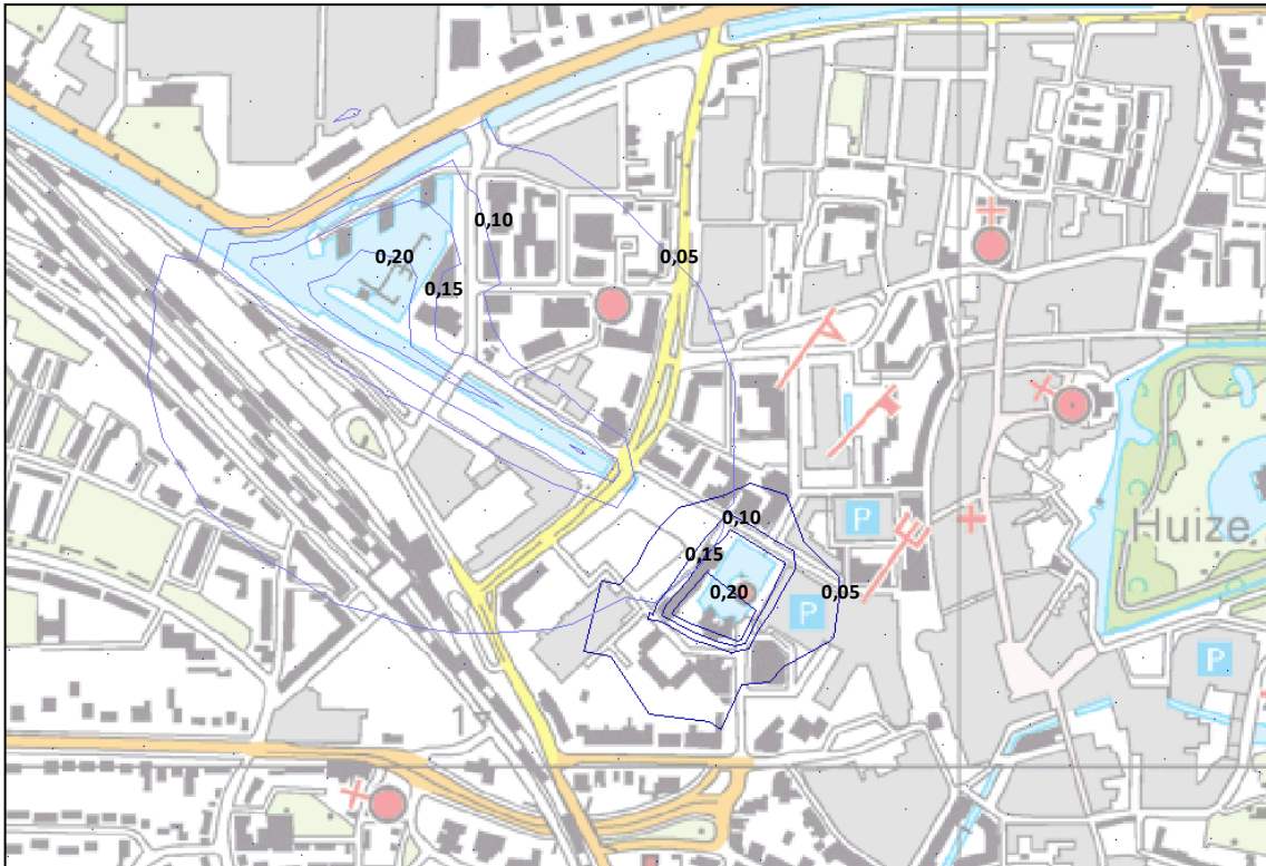
Figuur 2.2: Toename grondwaterstand door toevoeging van de haven, het kanaal en Stadsvijver in het model. Lichtblauw is de verhoging van de grondwaterstand a.g.v. toevoeging haven en kanaal, met donkerblauw is de verhoging a.g.v. Stadsvijver weergegeven
