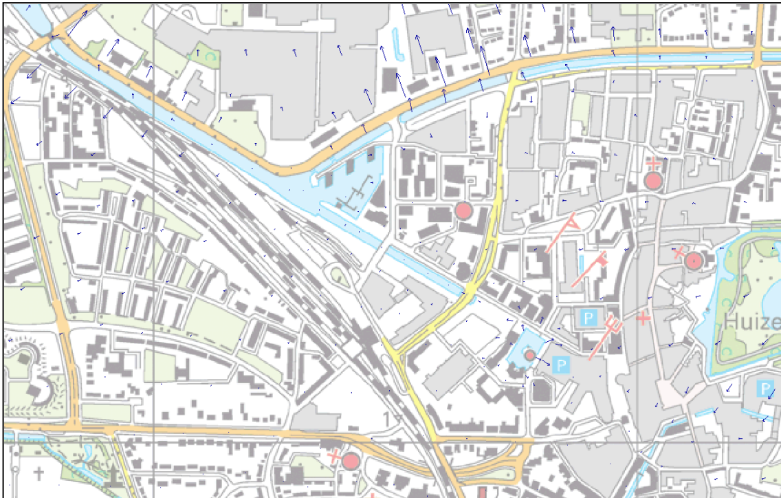
Figuur 2.3: Stromingsrichting grondwater freatisch pakket (De lengte van het pijltje geeft de mate van stromingssnelheid aan)
