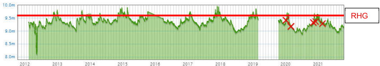
Afbeelding 4 Gemeten grondwaterstanden in monitoringspeilbuis Pb14.07 met afgeleide RHG (bron [5])
