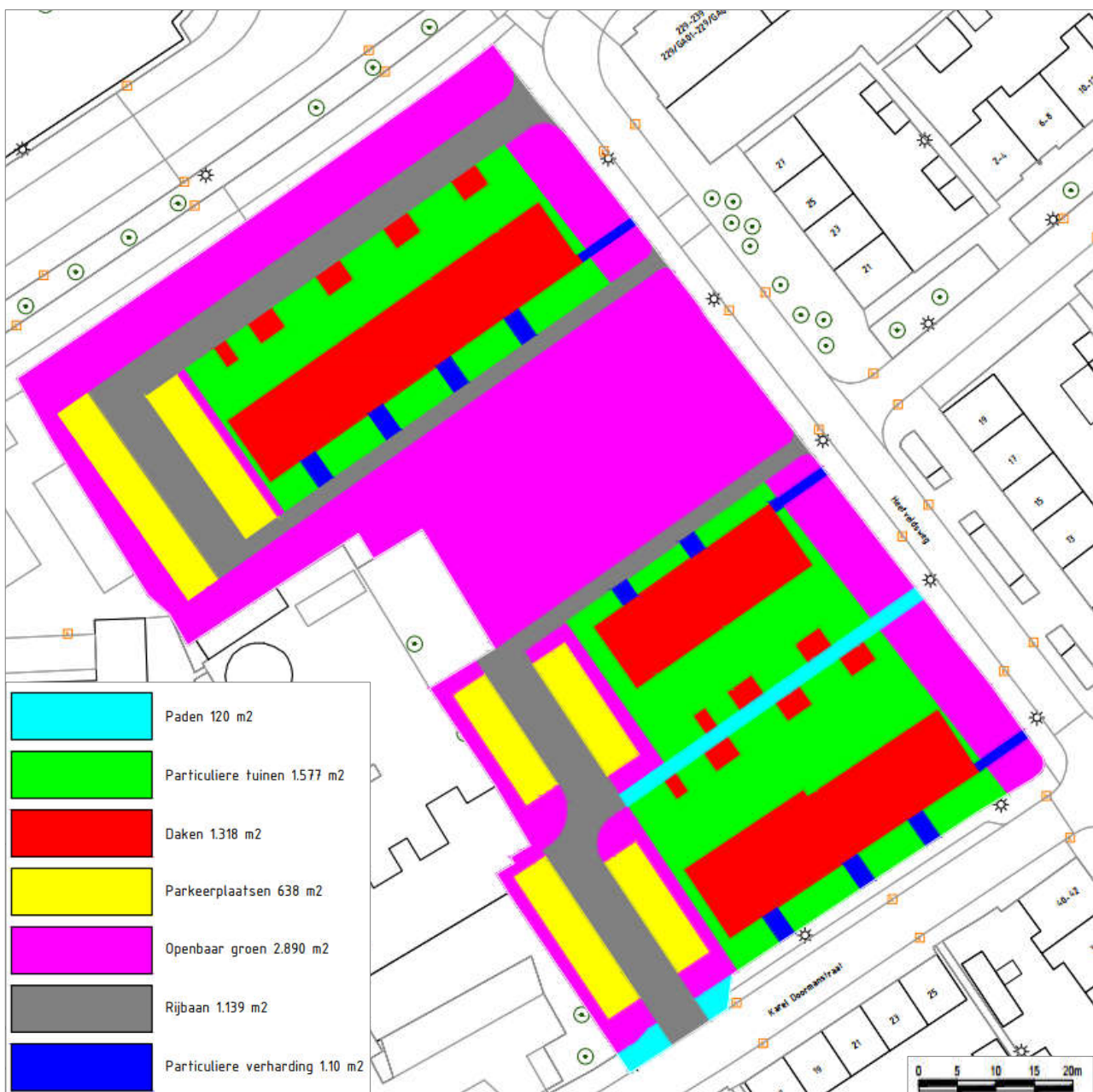
Afbeelding 6 Verdeling van oppervlaktes in het plangebied op basis van het stedenbouwkundig ontwerp
