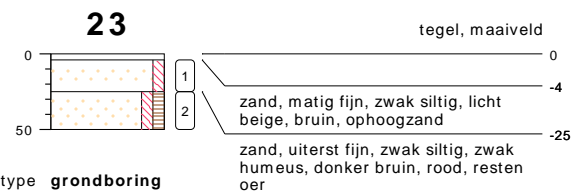
type grondboring datum 23-07-2019 boormeester J. Hartman
