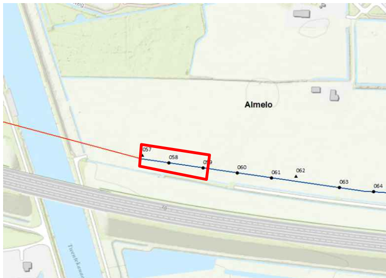
Afbeelding 7. Aanbevelingszone (rood kader) tussen boringen 57 en 59. Ontzien middels HDD en anders proefsleuvenonderzoek.
