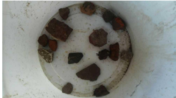
meetpunt 01, laag 0-50, bijz. puin 10838816
