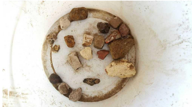
meetpunt 07, laag 0-50, bijz. puin 10838822
