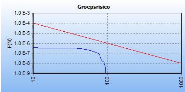
Figuur 17: De fN-curve voor deze kilometer leiding (A-528-deel-1 exclusief de verlegging).
