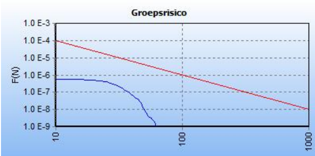
Figuur 14: De fN-curve voor deze kilometer leiding (A-508-deel-1 inclusief de verlegging).
