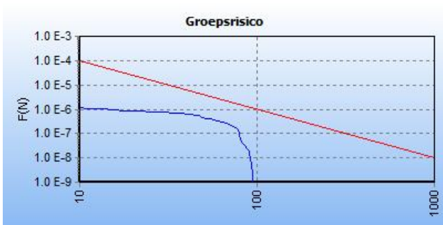
Figuur 11: De fN-curve voor deze kilometer leiding (A-508-deel-1 exclusief de verlegging).
