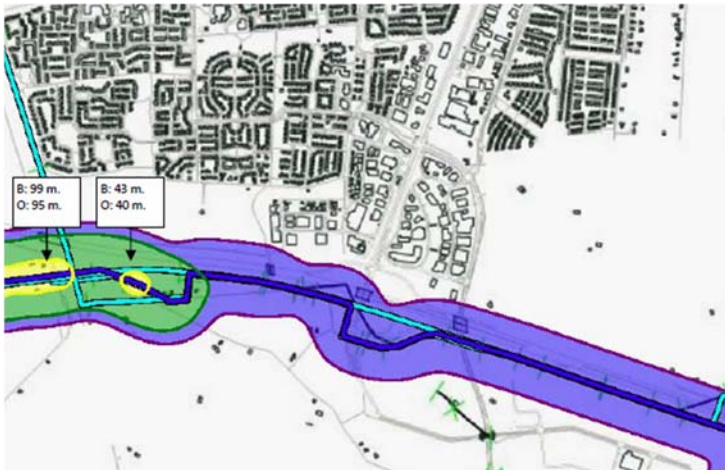
Figuur 5: Plaatsgebonden risicocontouren leiding A-508 (Bron: Risicoberekening gasleidingen Almelo, Oranjewoud, 2011) Paars = 10^{-8} /jaar, Groen = 10^{-7} /jaar, Geel = 10^{-6} /jaar
