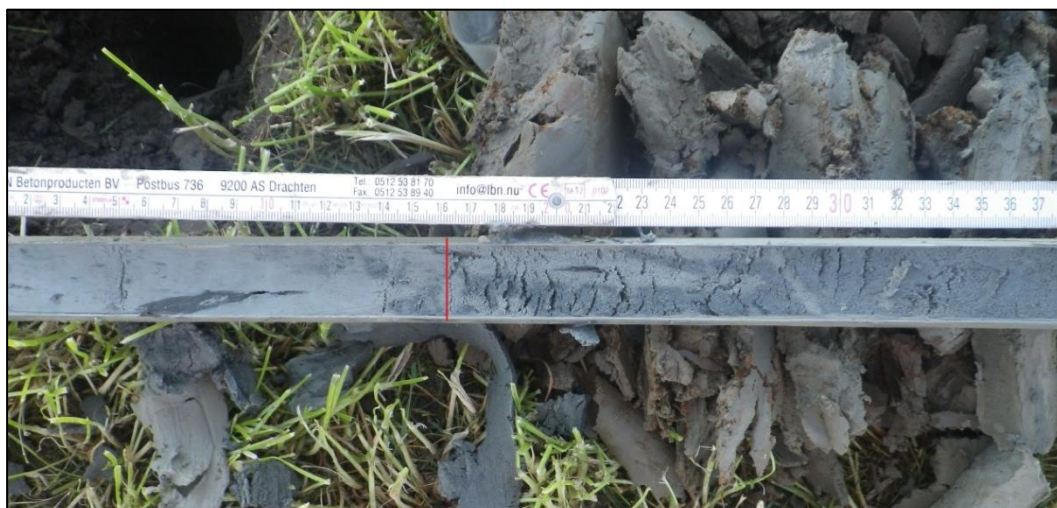
Afbeelding 10. Boring 2: de overgang van lichtgrijze slappe klei naar kwelderzand wordt gekenmerkt door een vlekkerige zone, waarschijnlijk als gevolg van de activiteit van pieren.
