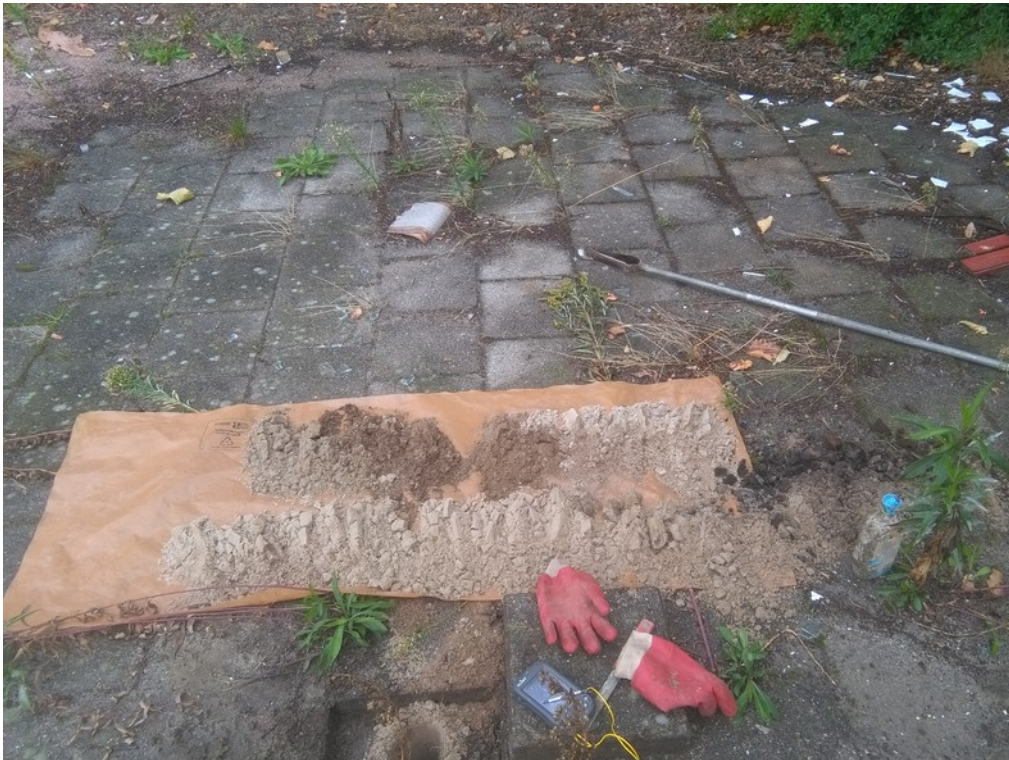
Figuur 5: Foto van de opgeboorde grond bij boring 1.
