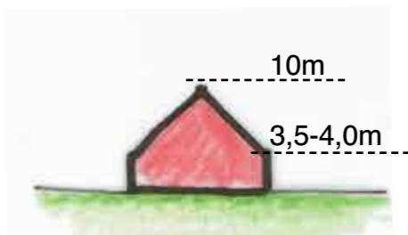
archetypische doorsnede - steile kap doorsnede
