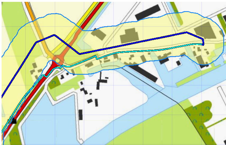
Figuur 3.1 A en B; Locatie van de hogedrukaardgastransportleidingen en met het invloedsgebied (in het geel)
