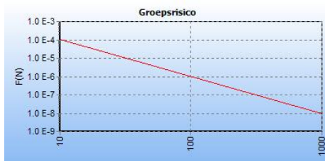
Figuur 5.1: fN-curve van het berekende groepsrisico met de oriëntatiewaarde (rode lijn)
