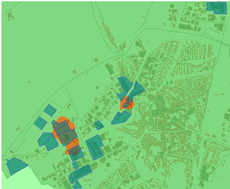
Figuur 2.3b : Fijn stof in Meppel; oppervlakte met 24-uurgemiddelde concentratie boven (oranje) en onder (groen) de 24-uurgemiddelde norm, volgens berekeningen op basis van uur-bij-uur methode (maar excl. lokale gradiënten t.g.v. verkeer); huidige situatie (2006) (gecorrigeerd voor zeezout).
