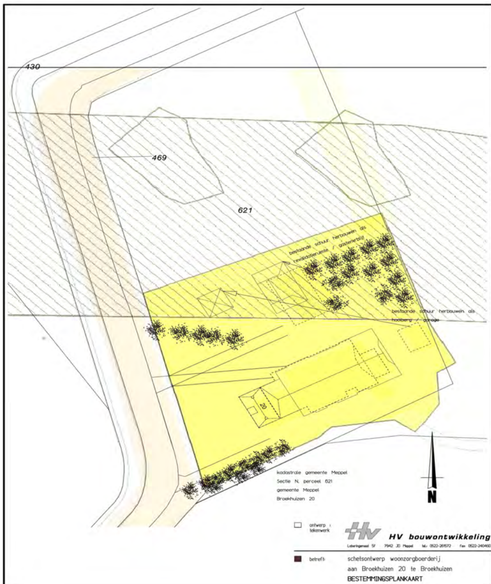
Afb. 10; Bestemmingsplankaart met de geplande ontwikkelingen in het geel gearceerde gebied. Noot: De arcering voor het deel met de dubbelbestemming waarde-archeologie komt niet overeen met de beleidskaart van gemeente Meppel. De arcering loopt over de zuidelijke helft van het perceel met nr. 621.
