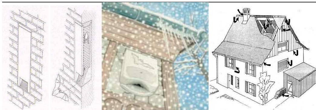
Figuur 8.1 Links: Vleermuiskoker welke in de muur kan worden ingebouwd, met vooraanzicht en dwarsdoorsnede. Midden: Vleermuizenkwartier winter 1WQ. Rechts: Vleermuizen verblijfplaatsen in de zomer. Bron: [www.waveka.nl]
