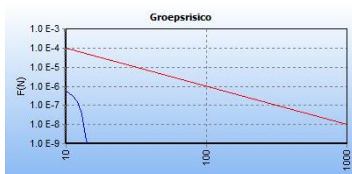
Figuur 5.3: fN-curve v/h berekende groepsrisico (blauwe lijn) met de oriëntatiewaarde (rode lijn)
