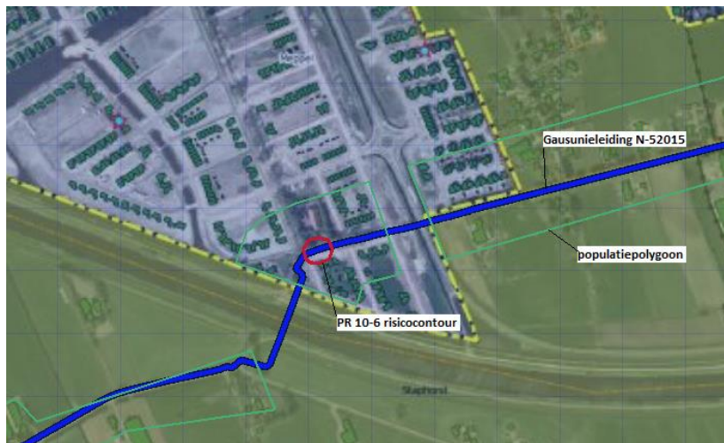
Figuur 5.1: Ligging van de 10-6 risicocontour van de gasleiding N-520-15
