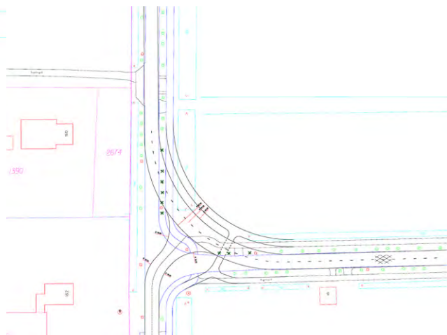
ontwerp aansluiting Riegshoogtendijk op Carstendijk
