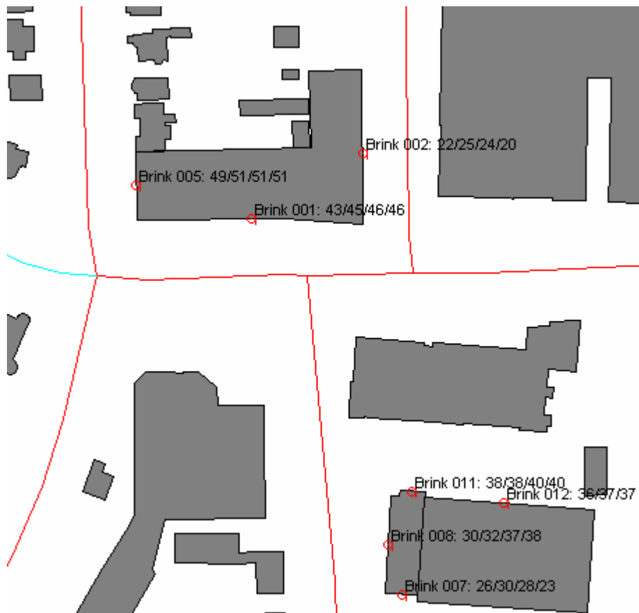
Figuur 3. Geluidsbelasting ten gevolge van de Stationsstraat
