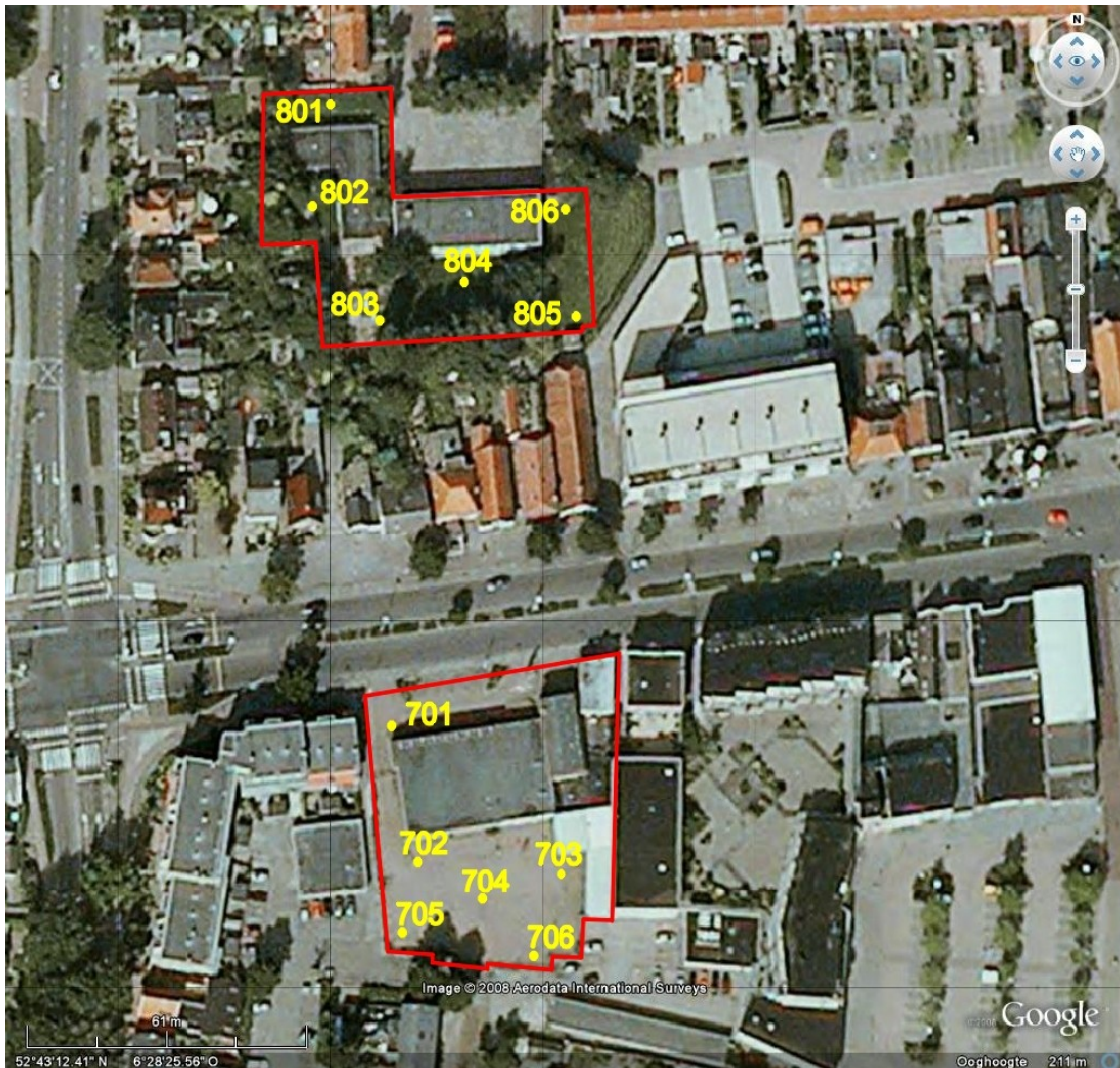
Figuur E: Hoogeveen, Bebouwde Kom: situatietekening van Locatie 7 Schutstraat en Locatie 8 Reviusplein met de boorlocaties. Met een rode lijn zijn de begrenzingen van de onderzoekslocaties aangegeven. De genummerde punten geven de uitgevoerde boringen weer (RD-coördinaten Locatie 7 Schutstraat NO – 228,425/526,395; ZO – 228,428/526,337; ZW – 228,379/526,332; NW - 228,376/526,387; 8 Reviusplein NO – 228,383/526,510; ZO – 228,418/526,457; ZW – 228,365/526,456; NW - 228,349/526,510).
