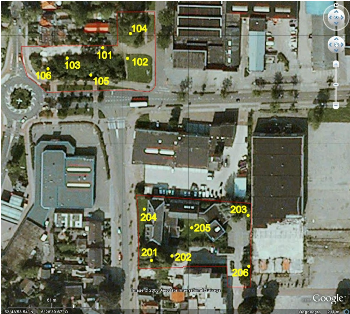
Figuur A: Hogeveen, Bebouwde Kom: situatietekening van Locatie 1 Stationsstraat en Locatie 2 Brinkstraat met de boorlocaties. Met een rode lijn zijn de begrenzingen van de onderzoekslocaties aangegeven. De genummerde punten geven de uitgevoerde boringen weer (RD-coördinaten Locatie 1 Stationsstraat NO – 228,649/527,795; ZO – 228,647/527,740; ZW – 228,569/527,742; NW – 228,558/527,774; Locatie 2 Brinkstraat NO – 228,712/527,666; ZO – 228,713/527,606; ZW – 228,642/527,619; NW – 228,640/527,666).
