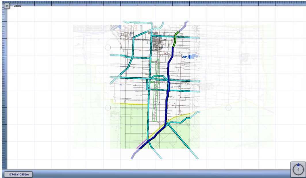
Figuur 4.12 Kilometer leiding behorende bij de maximale overschrijding van de FN-curve voor A-619 van N.V. Nederlandse Gasunie
