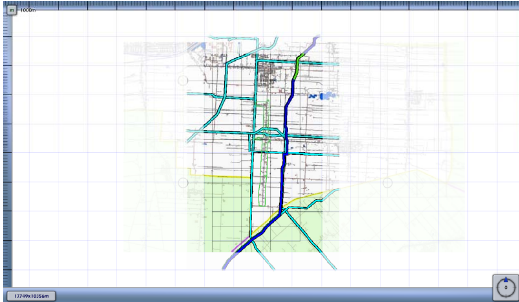
Figuur 4.13 Kilometer leiding behorende bij de maximale overschrijding van de FN-curve voor A-661 van N.V. Nederlandse Gasunie
