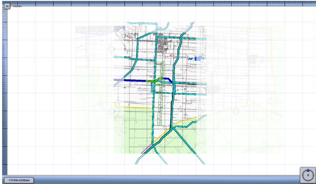
Figuur 4.10 Kilometer leiding behorende bij de maximale overschrijding van de FN-curve voor A-594 van N.V. Nederlandse Gasunie
