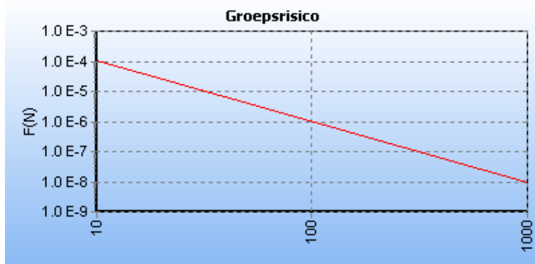
5.4 Figuur 5.10 FN curve voor A-594 van N.V. Nederlandse Gasunie voor de kilometer tussen stationing 7660.00 en stationing 8660.00
