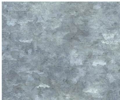
thermisch verzinkt stalen constructies
