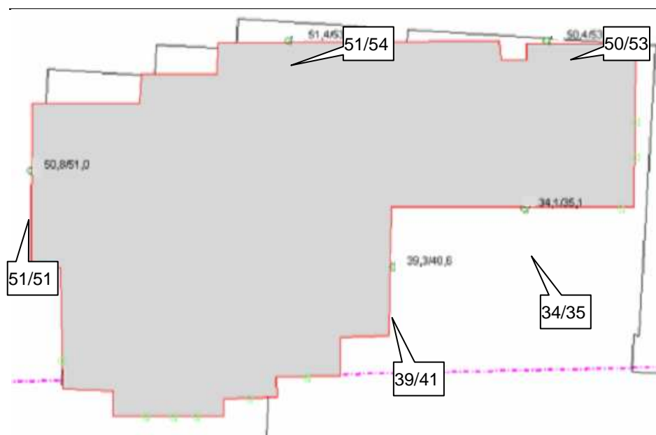
Figuur 3.1 Geluidbelasting dB(A) op de gevels van het hoekpand veroorzaakt door geluidgezoneerd industrieterrein De Wieken
