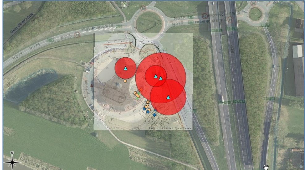
Figuur 1: PR10 -6 contouren LPG-installatie
