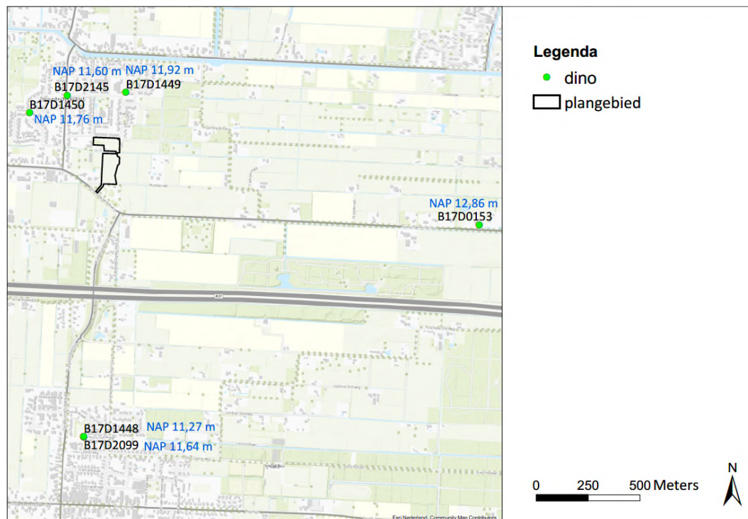
Figuur 2-3: Meetpunten grondwater (bron: Dinoloket). De blauwe label geeft een indicatie van de gemiddeld hoogste grondwaterstand.
