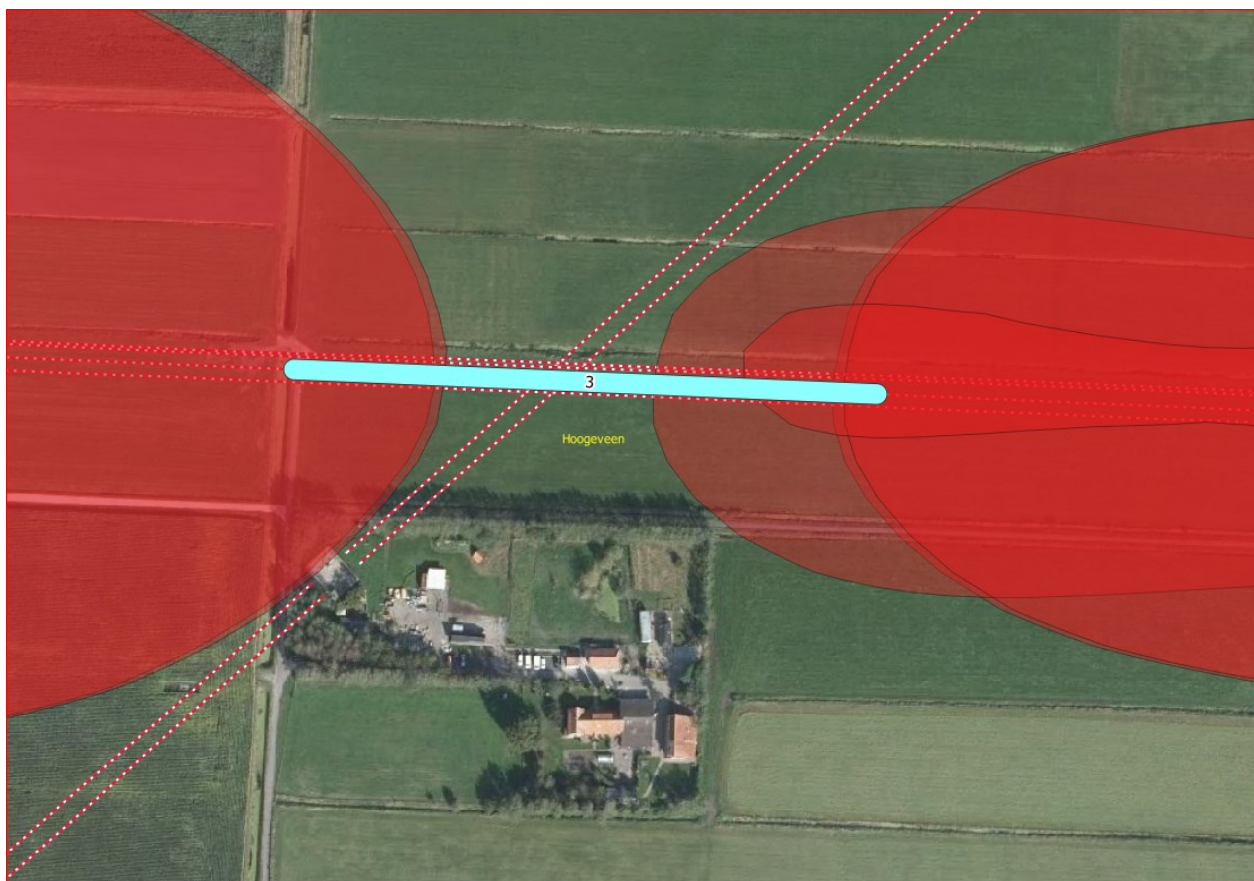
Figuur 10. PR10 -6 buisleidingen na maatregelen
