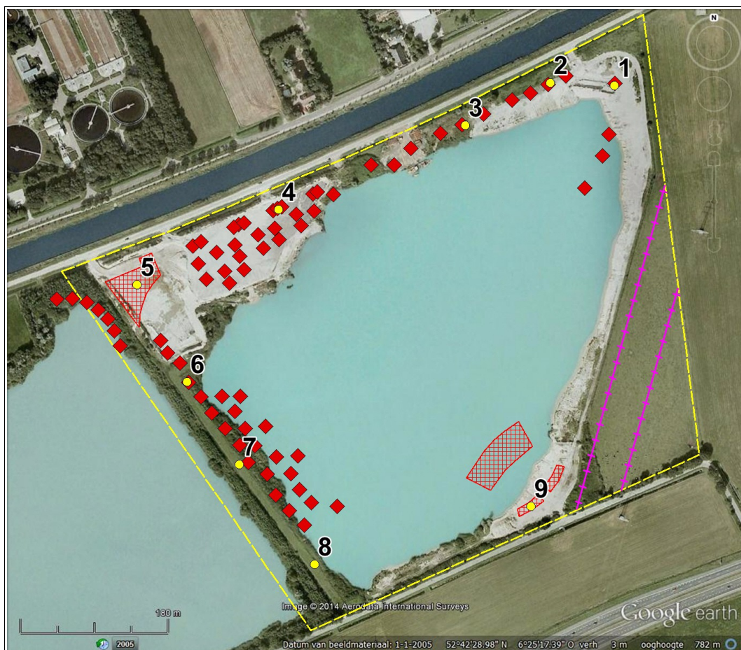
Figuur 7: Hoogeveen, Zandwinplas Nijstad: boorpuntenkaart. De gele contour is de grens van het onderzoeksgebied. De genummerde punten zijn de locaties van de boringen. Met rood zijn de locaties weergegeven van geplande huizen en paviljoens (zie Figuur 2).
