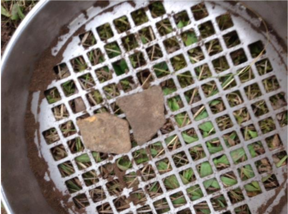
Foto 1: asbeststukjes uit G5
