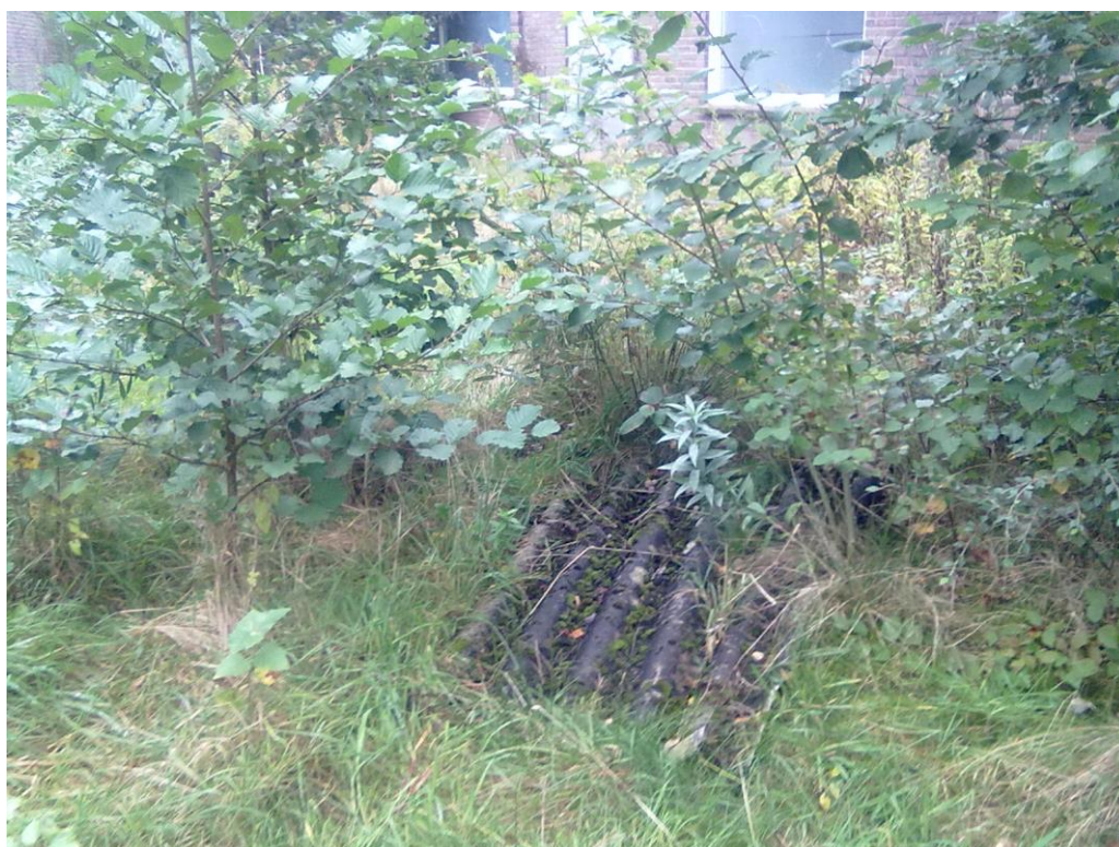
Foto 2: asbestverdachte golfplaten op maaiveld
