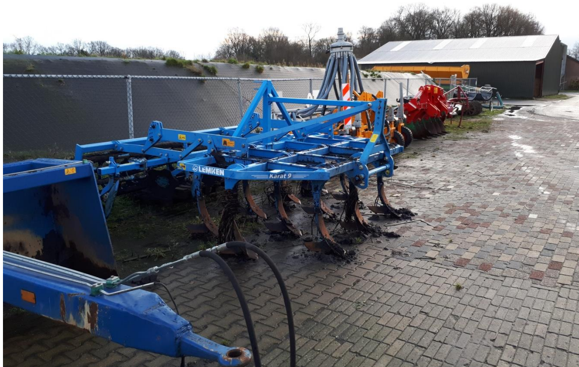
Afbeelding 3.2: Landbouwwerktuigen staand voor de deels boven- en deels ondergrondse mestopvang. Aan de hand van de tandhoogte (ruim 50 cm) is duidelijk te zien dat de bodemroering van de werktuigen vrij fors is.
