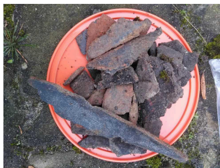
meetpunt G1, laag 25-65, bijz. asbestverdacht 91094330
