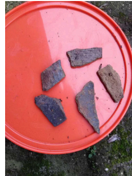
meetpunt G3, laag 35-60, bijz. asbestverdacht 91094332
