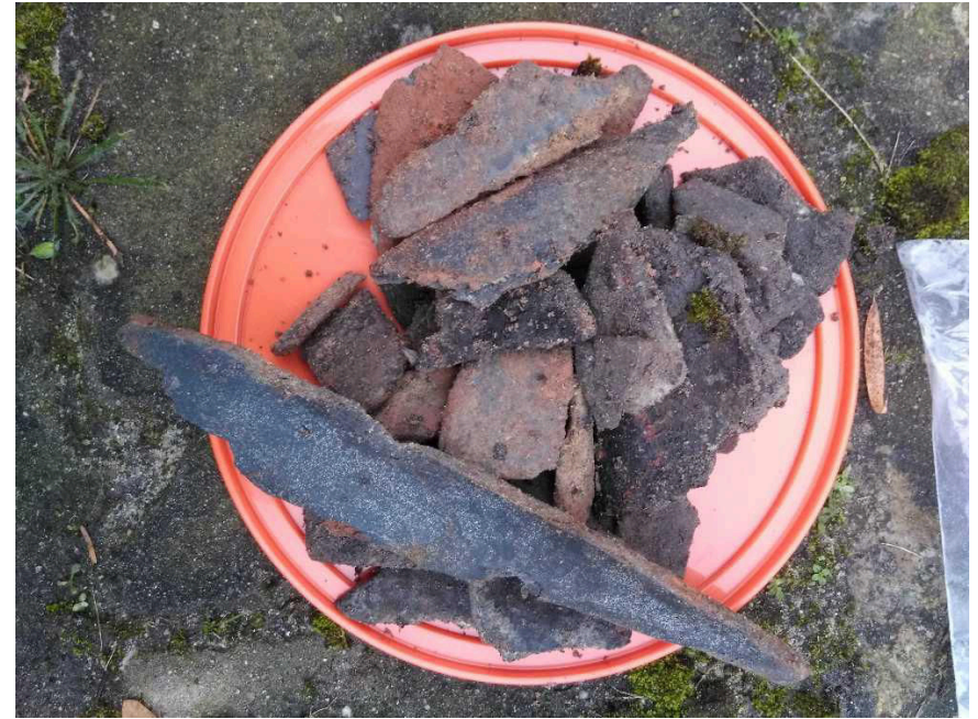
meetpunt G1, laag 25-65, bijz. asbestverdacht
