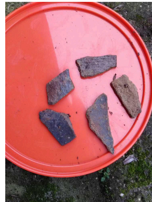
meetpunt G3, laag 35-60, bijz. asbestverdacht
