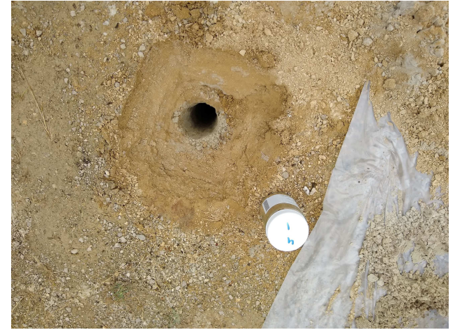
Foto 3: Inspectiegat halfverharding split
