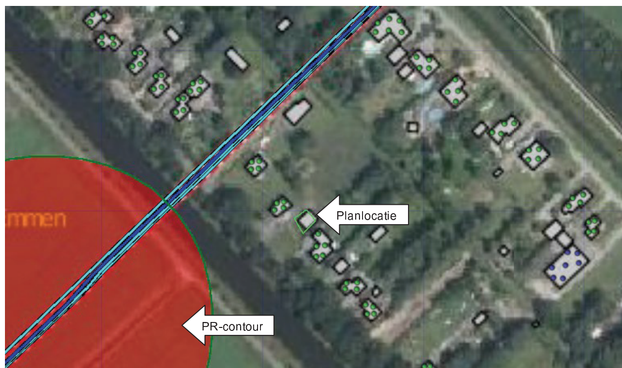
Figuur 3. Plaatsgebonden risico 10^{-6} van leidingen 000312 en 000510
