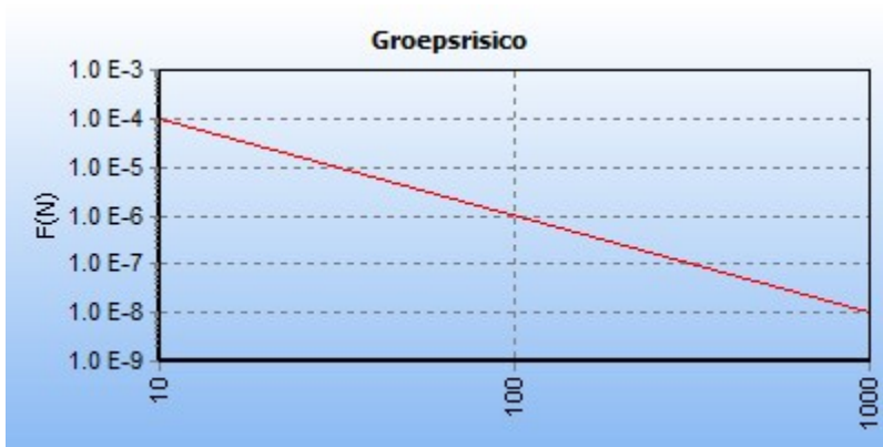
5.1 Figuur 5.2 FN curve voor 5072_leiding-A-582-deel-1 van N.V. Nederlandse Gasunie voor de kilometer tussen stationing 1970.00 en stationing 2970.00
