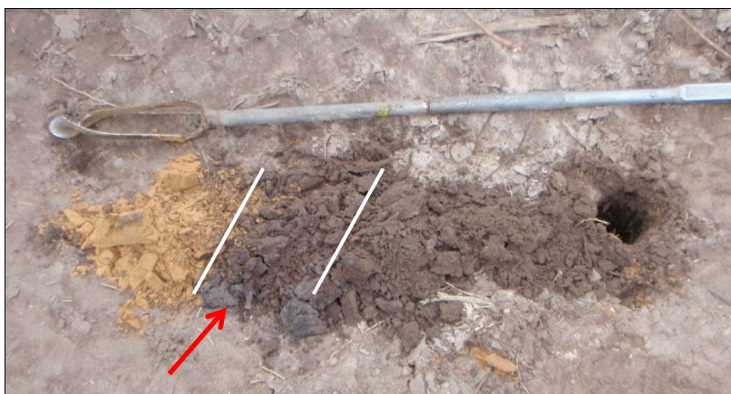
Afbeelding 13. Beeld van boring 2 waarbij de verstoorde bodemlaag met restanten van de podzolbodem met een pijl is aangegeven (foto: MUG Ingenieursbureau b.v.)
