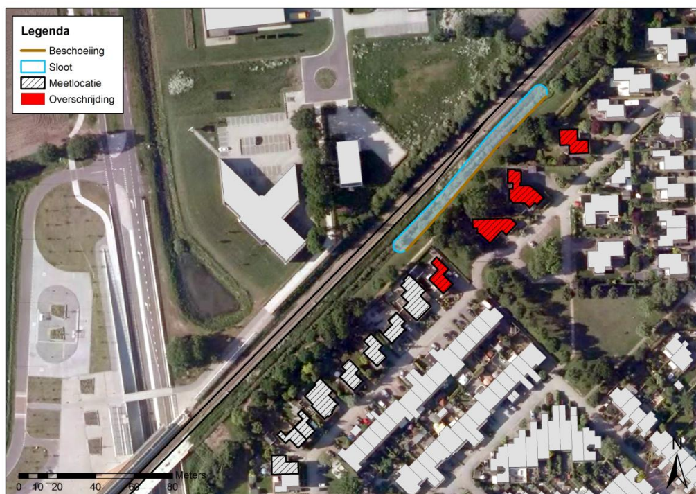
Figuur 7-4 Plansituatie met sloot van 7.3 meter diep met beschoeiing aan zijde bebouwing
