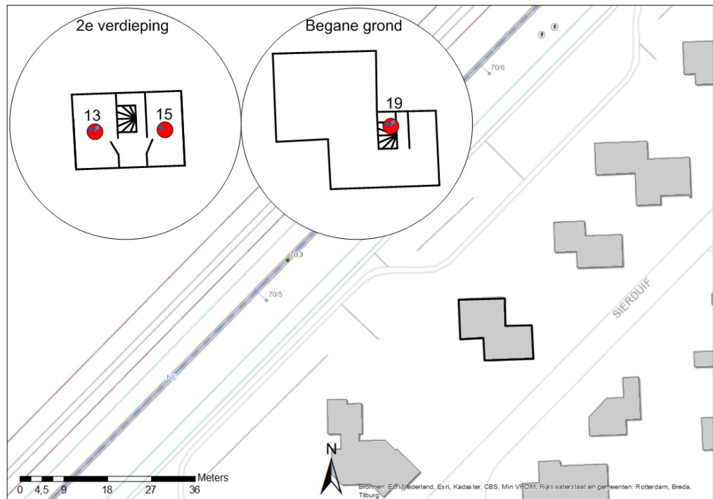
Figuur I - 5 Opstelling sensoren bij eerste meting Sierduif 11
