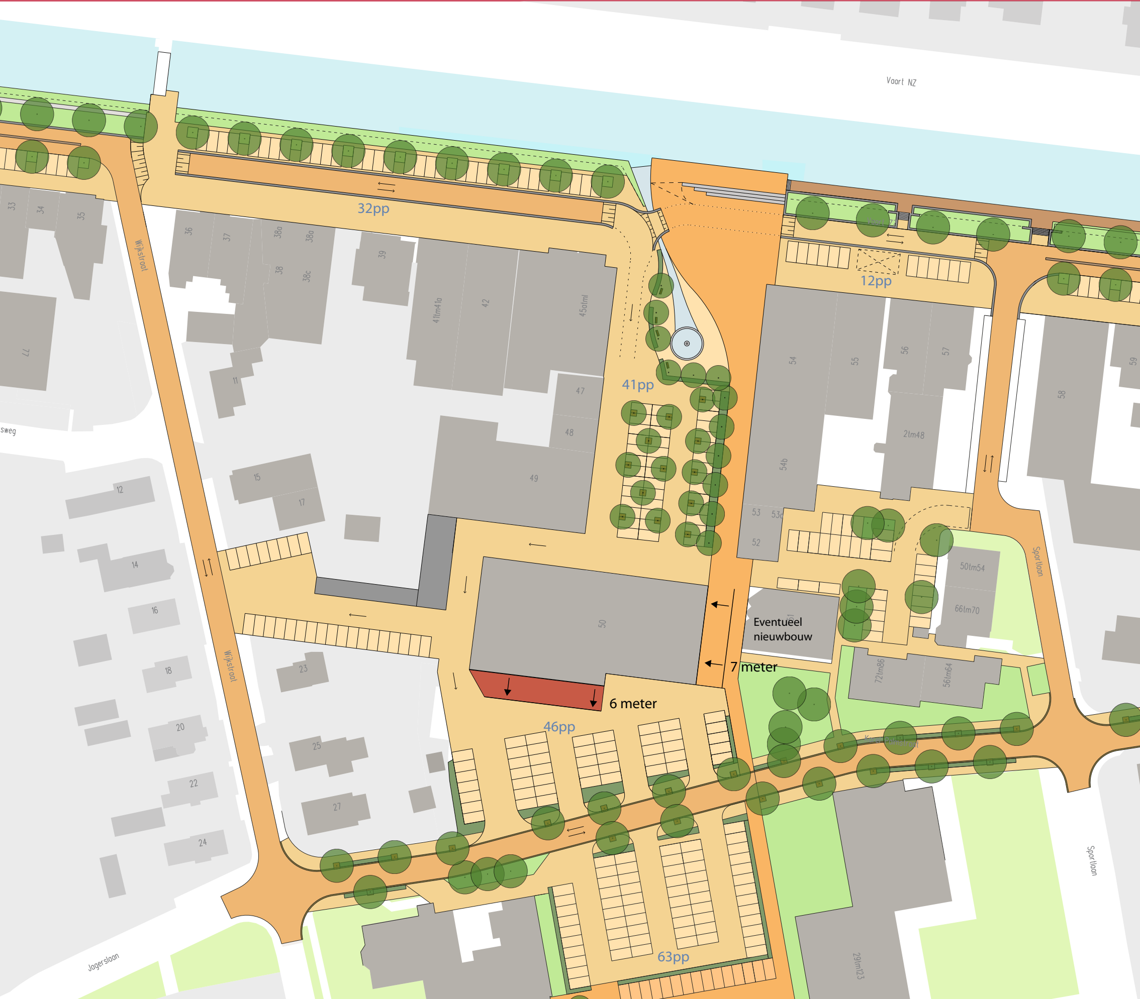
Gekozen pleinvariant: plein vanuit 2 richtingen toegankelijk voor de auto. Aanpassingen rondom de zuidelijke supermarkt
