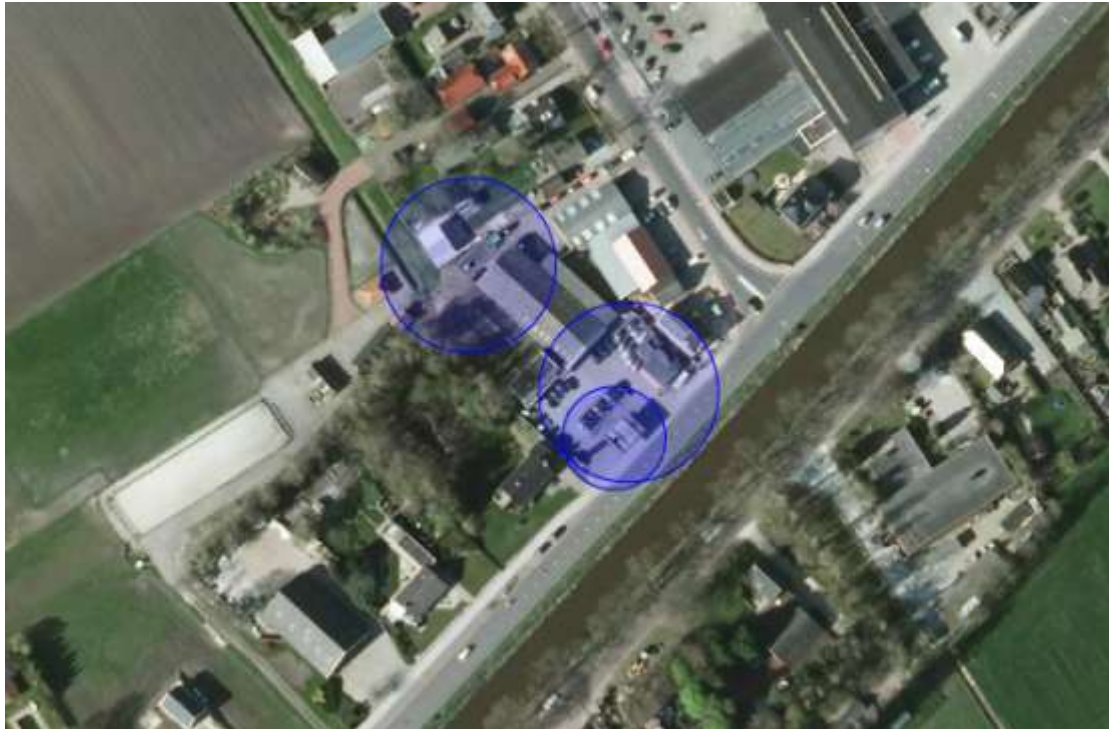
Figuur 5. LPG-Tankstation PR-contouren bestaande situatie (met maatregelen)
