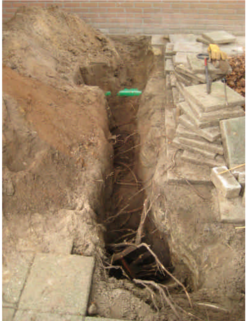
Foto 9/10/11: Op ruim 1m afstand uit de gevel van de woning werd een rioolbuis ingegraven. Tot op ongeveer 2m afstand van de gevel zijn in deze profielsleuf voornamelijk fijnere wortels gevonden. Vanaf 2m afstand uit de gevel neemt de bewortelingintensiteit sterk toe, evenals de omvang van de wortels. De foto hieronder is bij benadering gesitueerd op de plek waar de hoek van het nieuwe gebouw zou moeten komen. De wortels groeien in de richting van de nieuwbouw.
