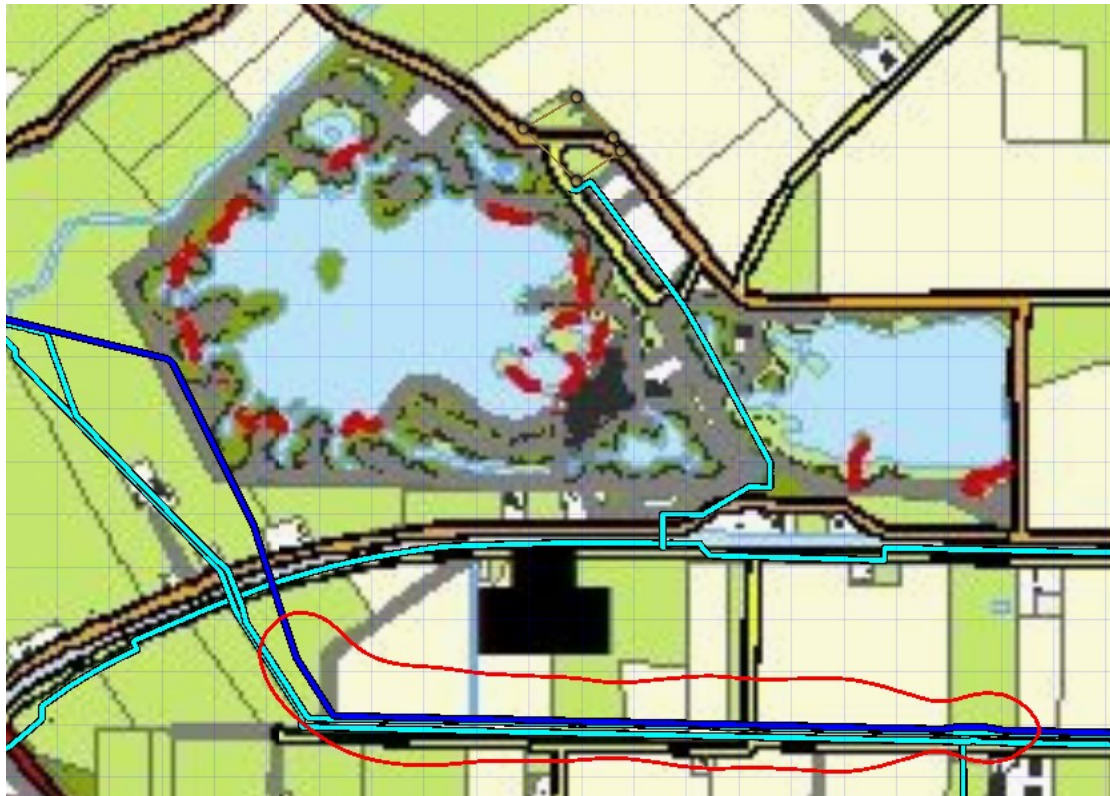
Figuur 11: plaatsgebonden risicocontouren leiding A-594-03
