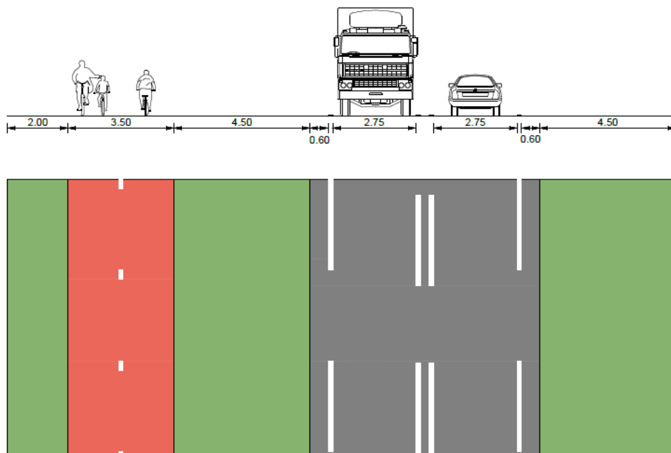
Figuur 1.2 principeprofiel GOW type I, 80km/uur
