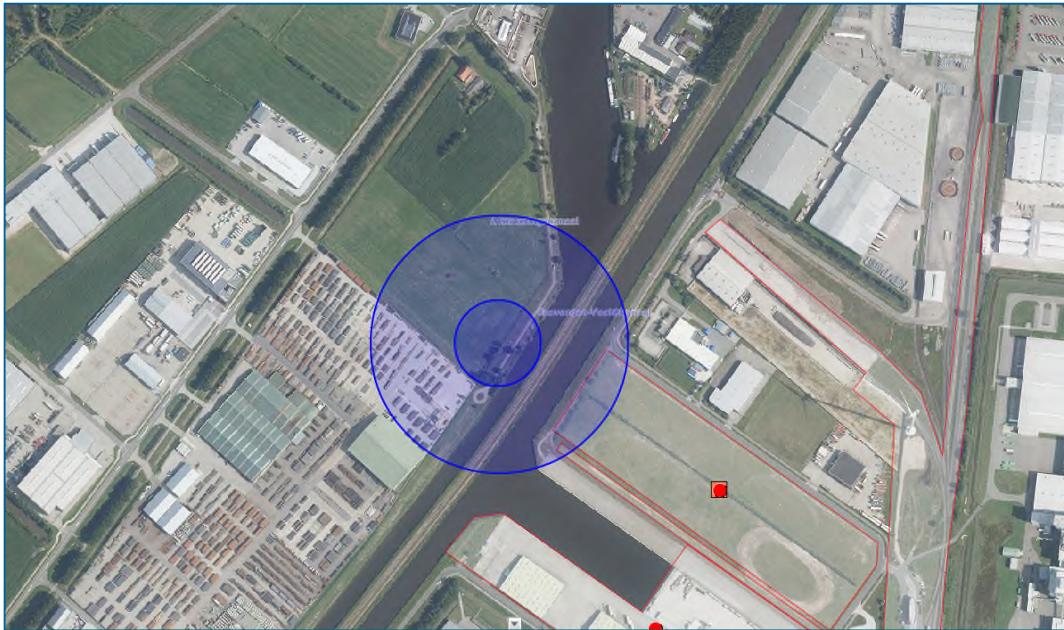
Figuur 4.2b Effectafstand mastbreuk (172 m buitenste cirkel) en effectafstand gondel- en/of rotorafworp (57 m binnenste cirkel)
