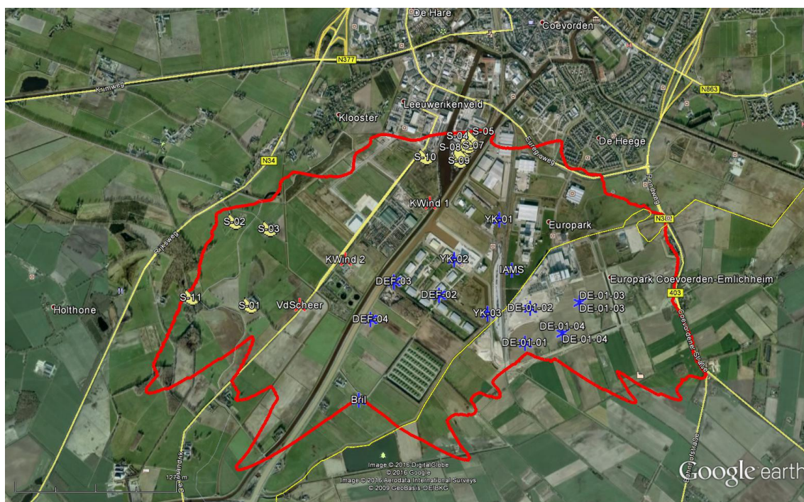
Figuur 2: slagschaduwduur cumulatieve situatie. De rode contour betreft de contour behorende bij 5 uur en 40 minuten per jaar slagschaduw
