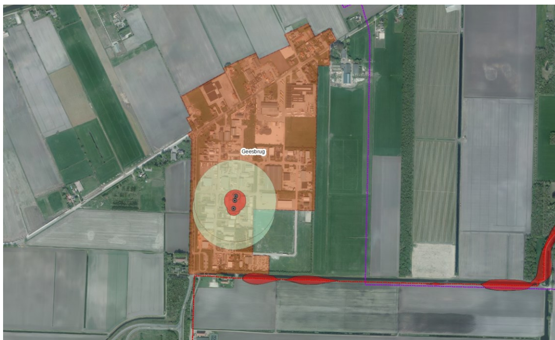
Figuur 20. PR10E-06 buisleiding Gasunie N-522-50 ten zuiden van Geesbrug
