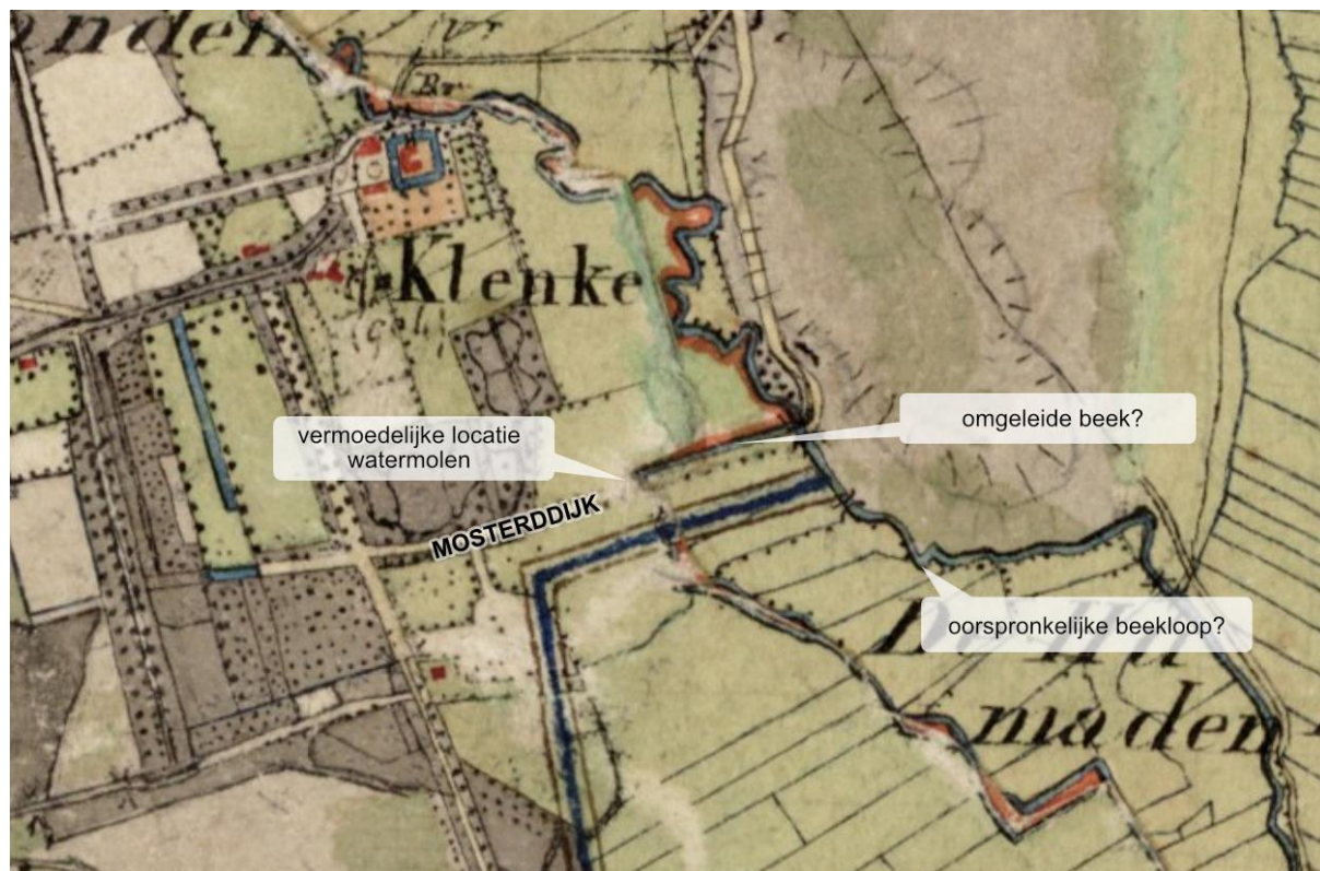
Figuur 10. Ten behoeve van het functioneren van de watermolen werd de beek mogelijk omgeleid (TMK veldminuut omstreeks 1845).
